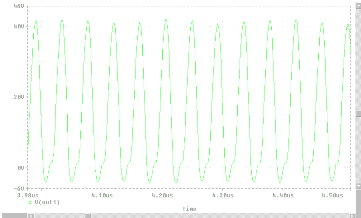
Figure 19: Simulation Tension/Temps avec C=0.47\text{nF} et L=100\text{nH} fréquence fondamentale
