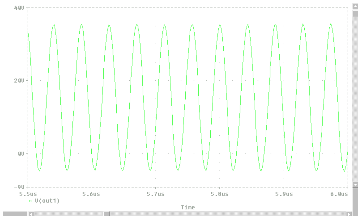
Figure 18: Simulation Tension/Temps avec C=4.7\text{nF} et L=10\text{nH} fréquence fondamentale
